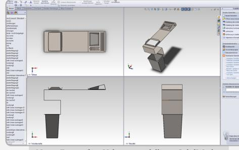
Neuer Entwurf im Volumenmodellierer SolidWorks
